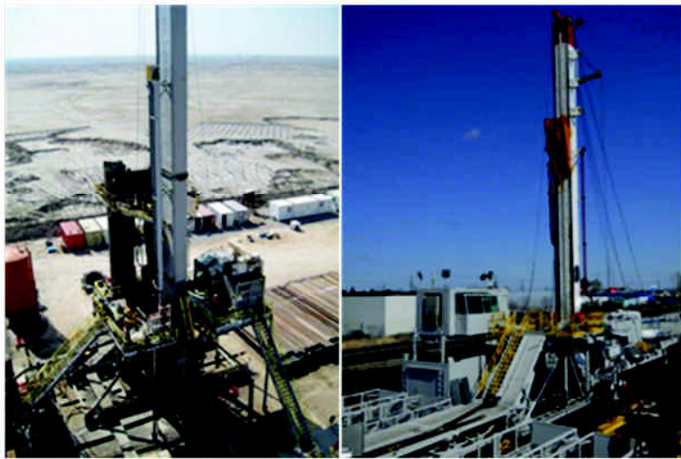
Figur 3.5 Landrigg på 250 tonn til venstre og 150 tonn til høyre (TSS Energy AS)
